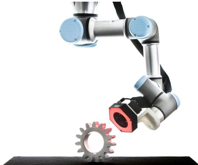
**Demo-System: Optische Kontrolle komplexer Produkte mit dem Ziel, die komplette Inspektionsumgebung zu simulieren. ©Fraunhofer ITWM**
